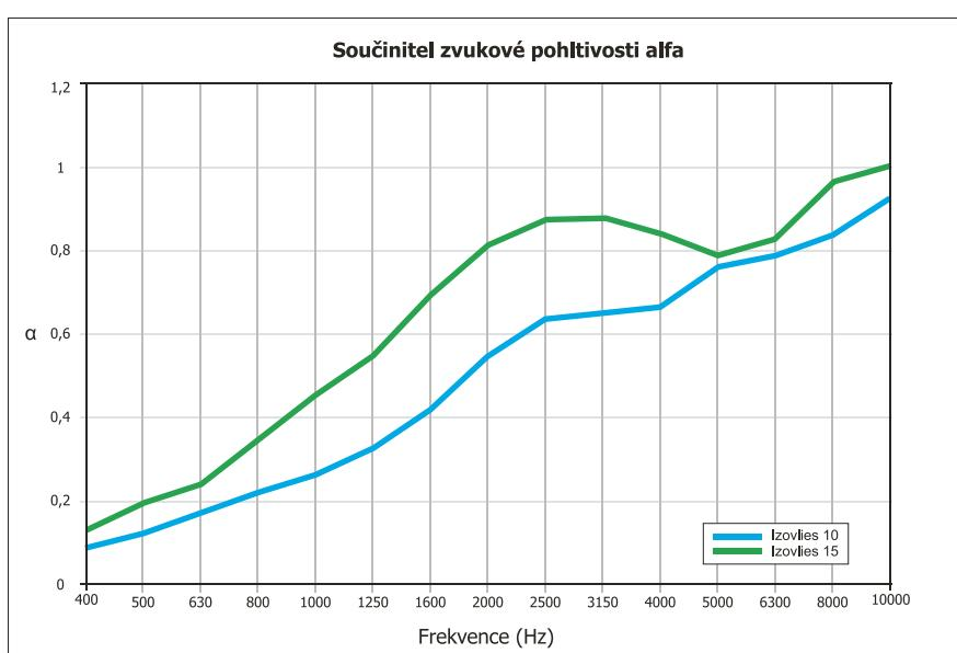
O výborných akustických vlastnostech svědčí měření zvukové pohltivosti provedené v alfa komoře.
